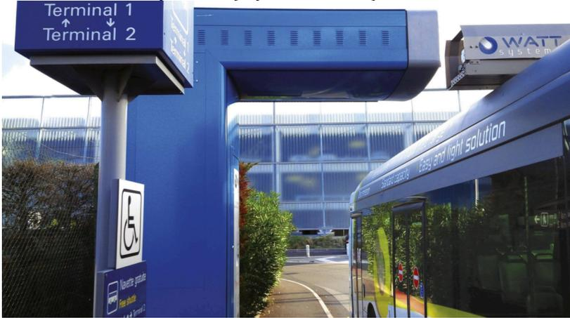
Le système WATT, expérimenté à Nice depuis octobre 2014, permet de recharger en quelques secondes les bus lorsqu'ils stationnent aux arrêts. Ils fonctionnent intégralement à l'électricité et permettent ainsi de se déplacer sans polluer
